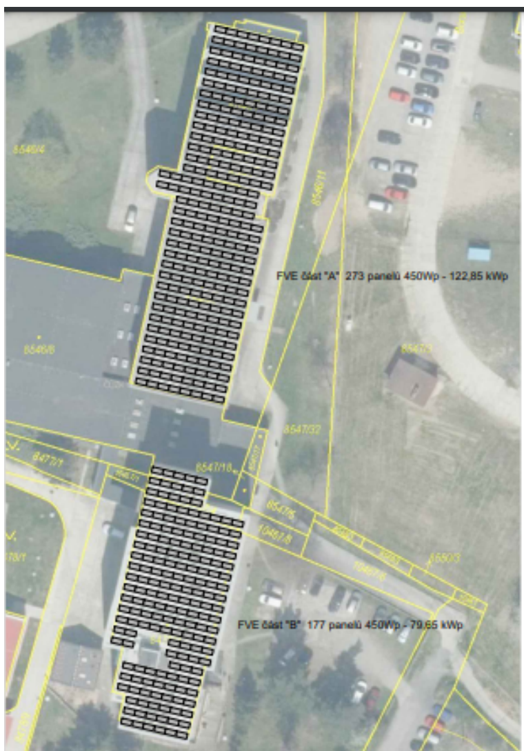
Obrázek 13 Dispozice FVE panelů na objektu č. 1 a 2
